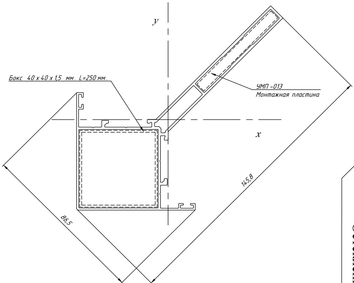
Соединение стоек по длине предусмотрено с использованием монтажной пластины УМП-013 и бокса 40x40x1,5 мм. L=250мм. Крепление к перекрытиям предусмотрено с использованием кронштейнов УМП-048 и опор УМП-077, УМП-077-01.
